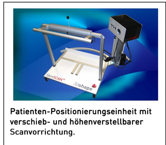
Patienten-Positionierungseinheit mit verschieb- und höhenverstellbarer Scanvorrichtung.
